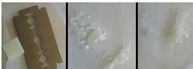
Рисунок 2.9 – Фото, показывающее, как измельчается образец твёрдого геля.
