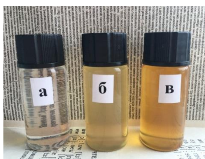
Рисунок 4.20 – Образцы вазелинового масла: №1 – исходное ВМ, не подвергнутое ТОД; № 2 и 3 – использованное ВМ в процессе получения волокна 3 и 5 раз, отобранное после стадии грубой очистки [210].
