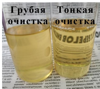
Рисунок 4.17 – Образец ВМ после стадии грубой очистки и образец, прошедший стадию тонкой очистки.
