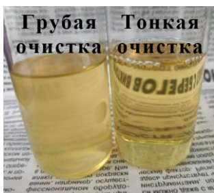
Рисунок 16 – Образец ВМ после стадии грубой очистки и образец, прошедший стадию тонкой очистки.
