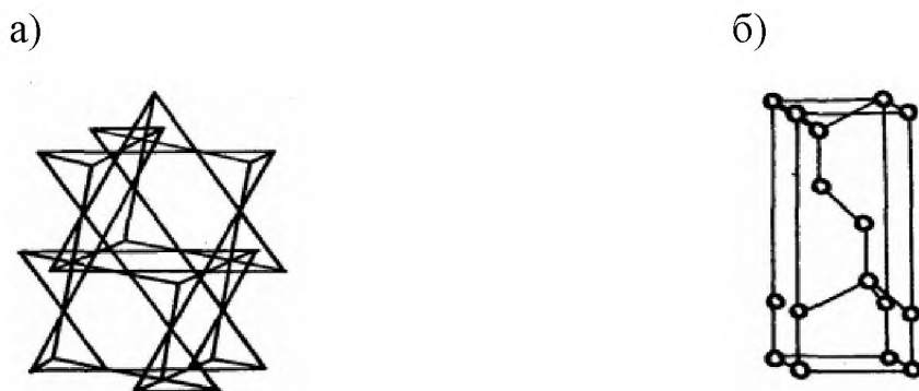
Рис. 4. Подрешетки из M (а) и R (б) атомов в структуре интерметаллида RM_2 типа C15.
