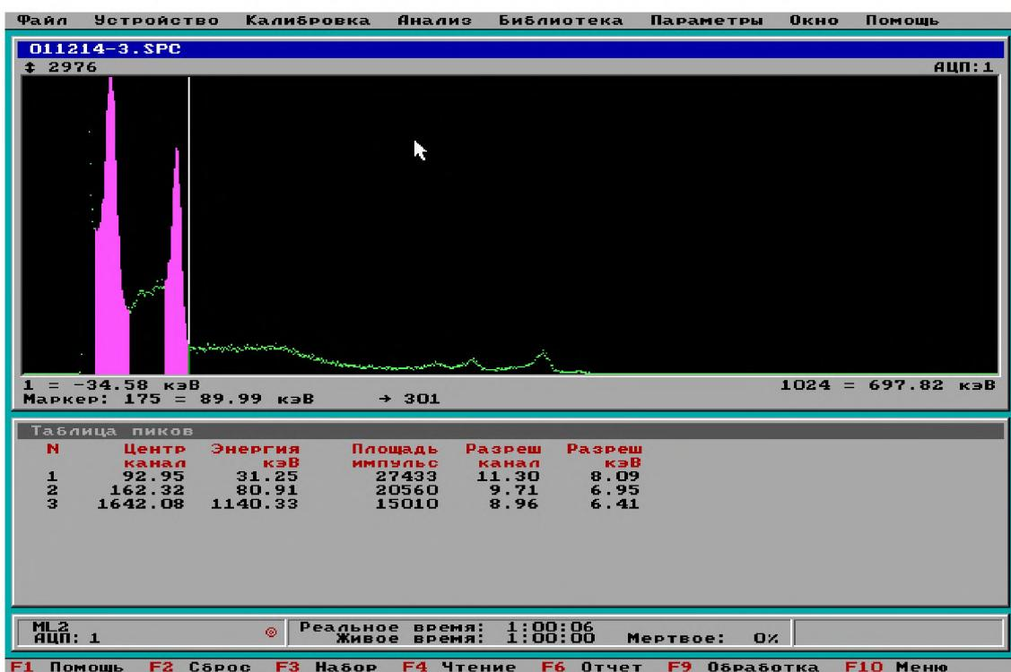
Рисунок 5.7. Спектр амплитудного распределения импульсов гамма-излучения нуклида  $^{133}\text{Ba}$ , измеренный детектором №1
