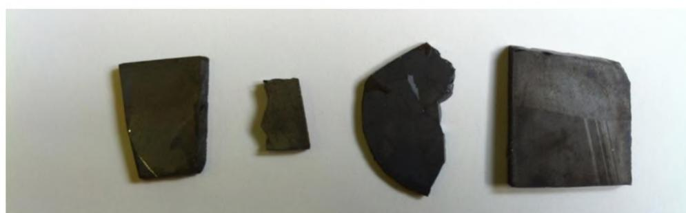
Рисунок 4.4. Монокристаллический CdTe РНИИРП для отработки технологии и режимов резки и шлифовки детектирующих структур
