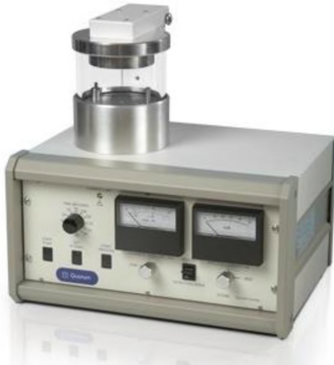
Рисунок.2.2 Изображение мини-установки по напылению Quorum SC7620.
