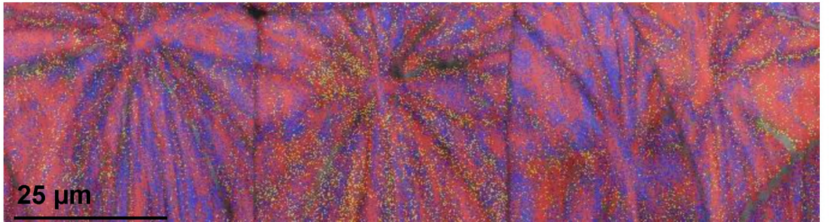
Рисунок 3.16 Контраст дифракционных полос с наложенной картой фаз, полученный для пленок, отожженных при 555 °С (а), 560 °С (б), 570 °С (в)
