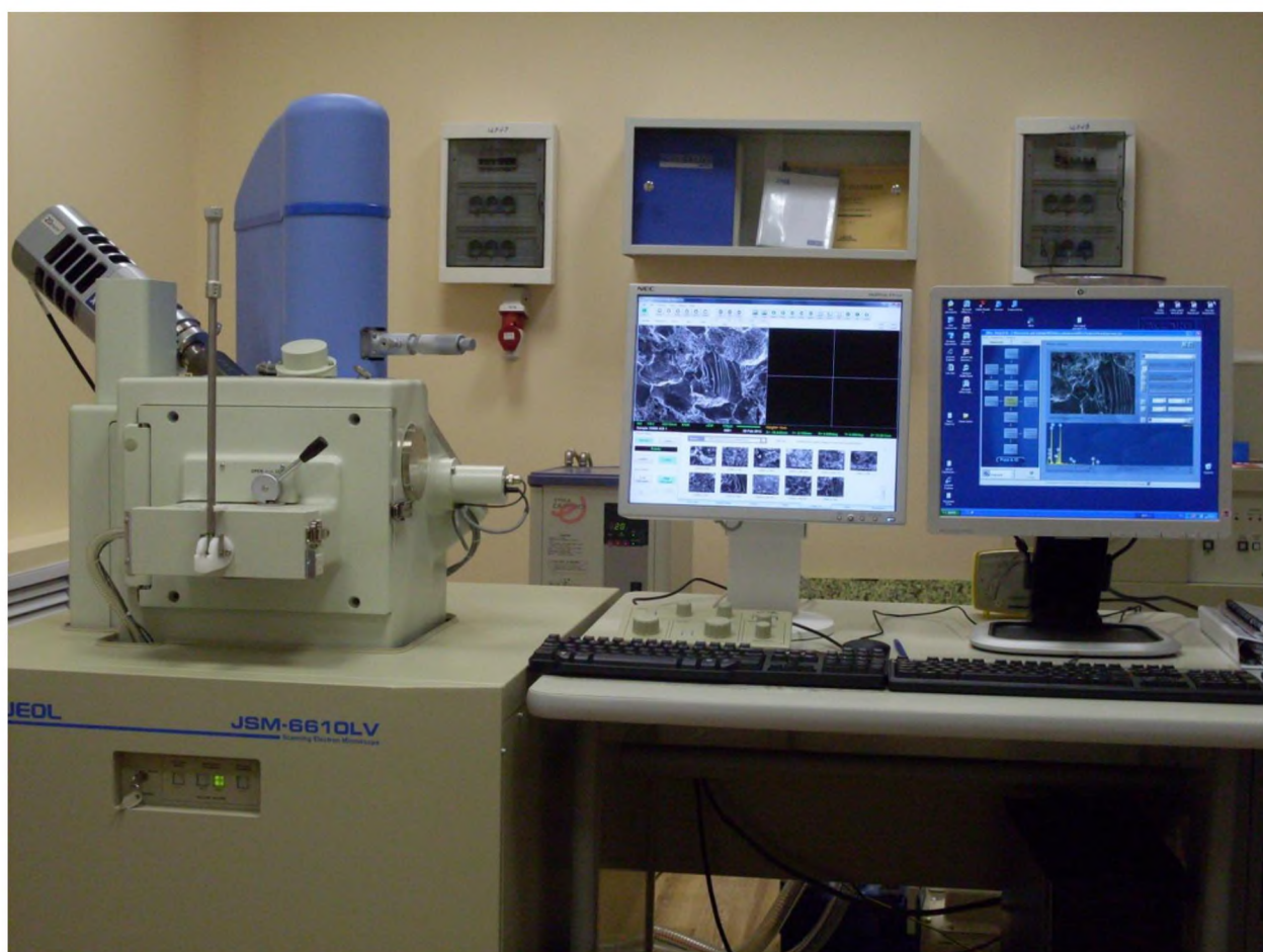
Рис. 2.1 Внешний вид растрового электронного микроскопа, оснащенного энергетический спектрометром
