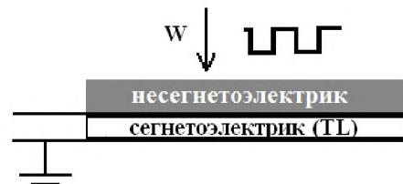
Рис. 1. Схема регистрации пироотклика при измерении коэффициентов температуропроводности и теплопроводности TSM методом
