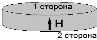
Рис. 3.17. Направление импульсного магнитного поля, приложенного к образцу феррита бария.
