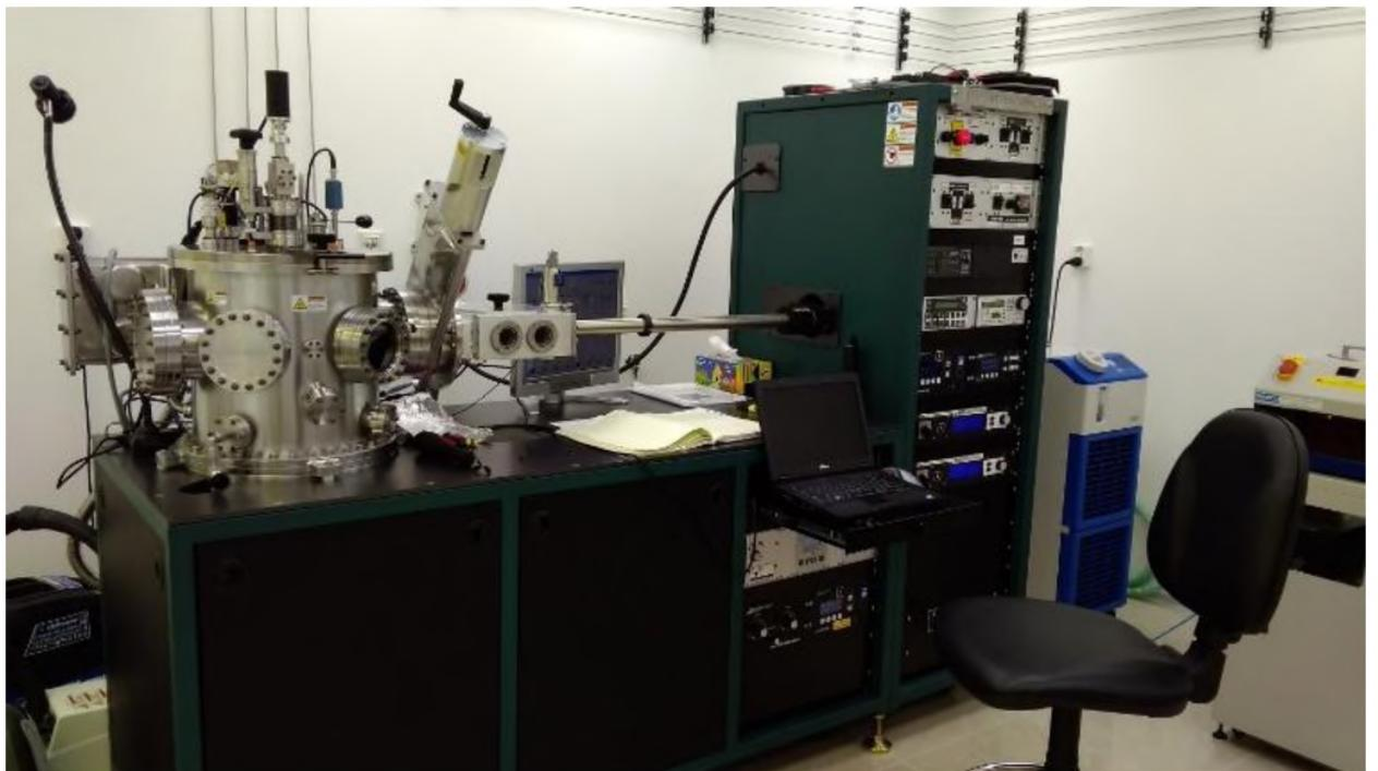
Рисунок 2.4. Фотография установки магнетронного распыления ORION-8-UHV, производства AJA International (США).
