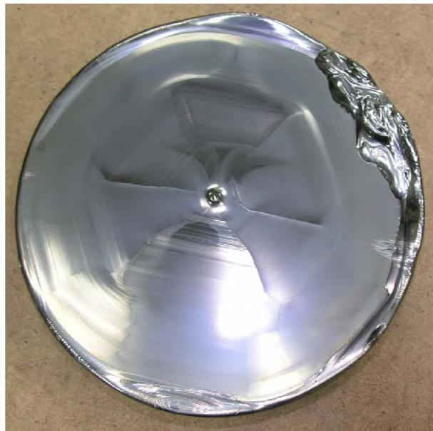
Рисунок 4.6 – Поверхность кристалла германия с характерным гексагональным расположением неровностей рельефа
