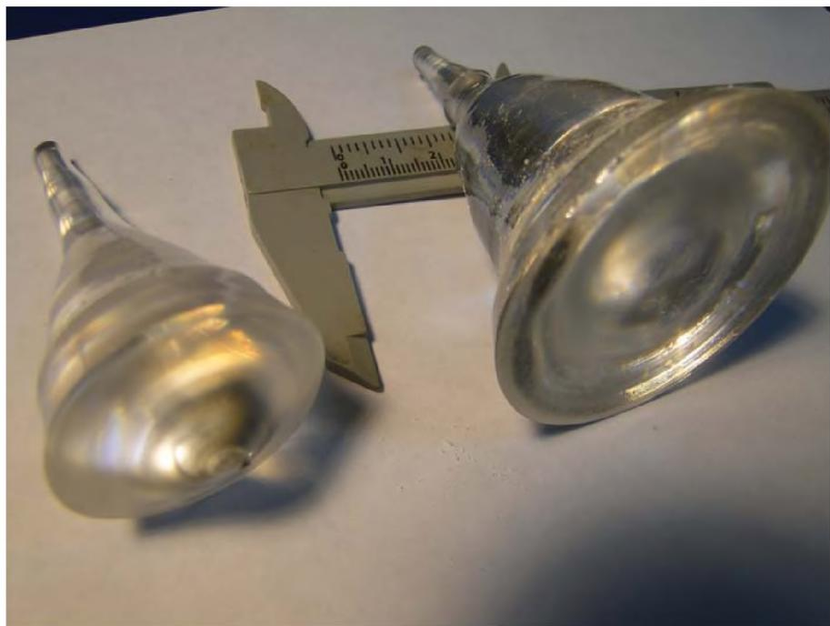
Рисунок 2.2 – Монокристаллы парателлурита с выпуклой (слева), и вогнуто-выпуклой (справа) ФФК
