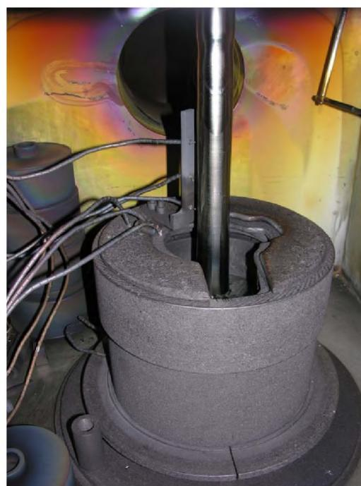
Рисунок 3.25 – Тепловой узел установки с выращенным кристаллом
