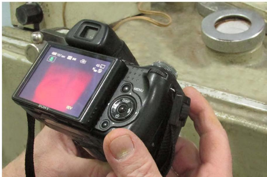
Рисунок 3.13 – Фотосъемка через смотровое окно камеры установки Редмет-15 поверхности расплава в тигле с монокристаллом парателлурита, выращиваемым методом Чохральского
