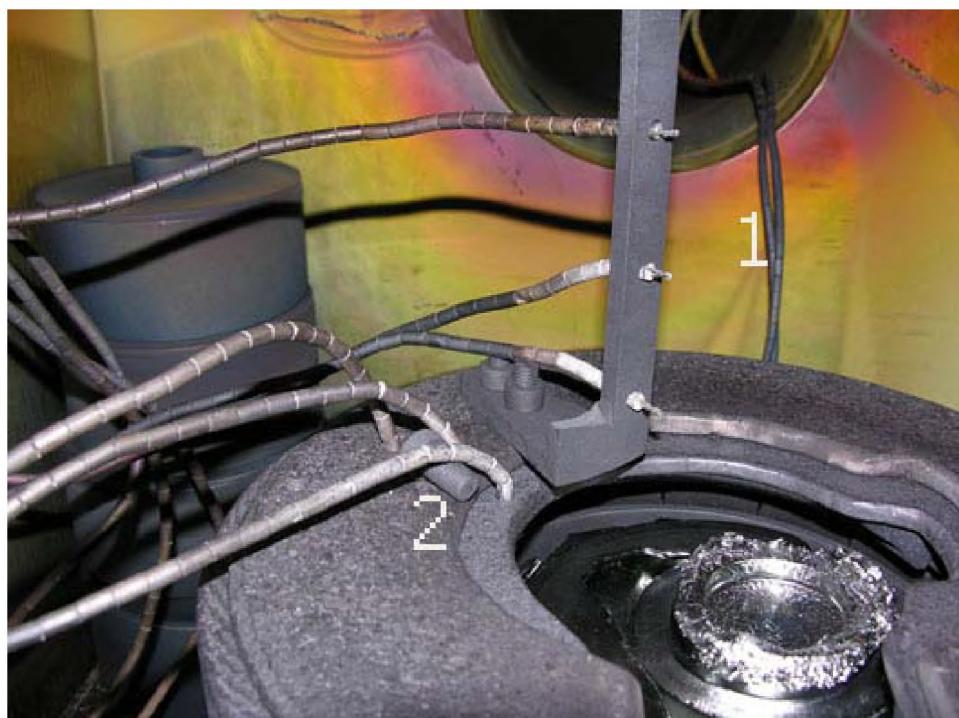
Рисунок 3.23 – Расположение термопар в системе: 1 – по оси системы; 2 – по радиусу системы
