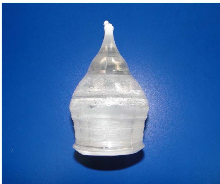
Рисунок 4.17 – Монокристалл парателлурита, выращенный до корректировки управляющих параметров
