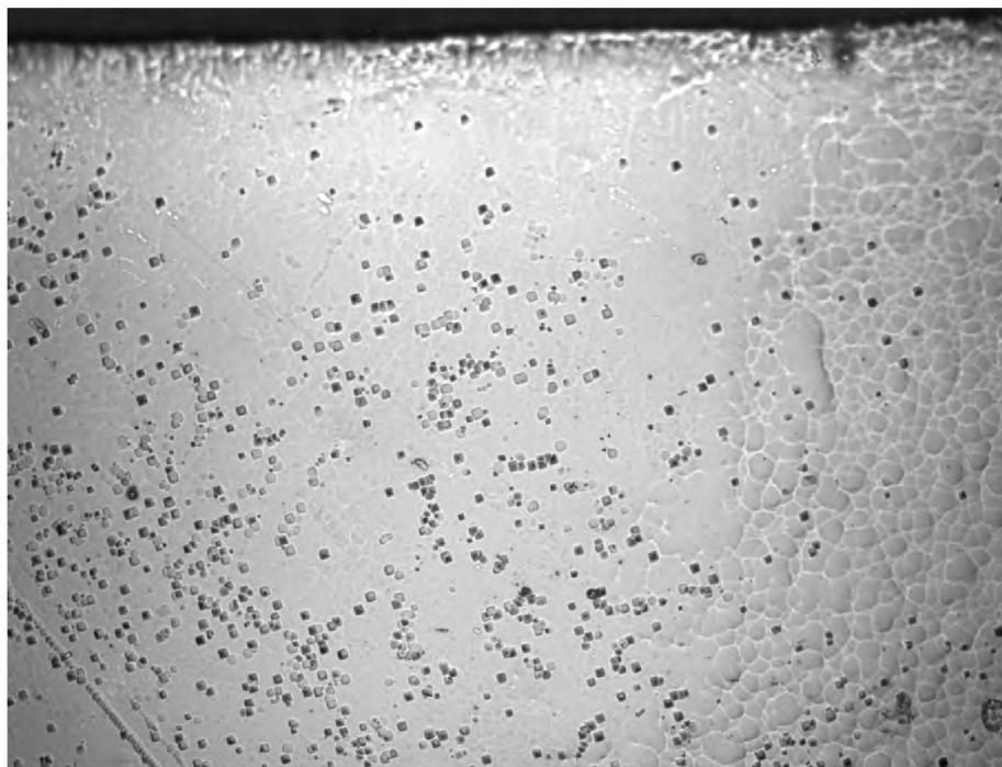
Рисунок 4.13 – Распределение дислокационных ямок травления на поверхности, соответствующей послойному механизму роста парателлурита.
