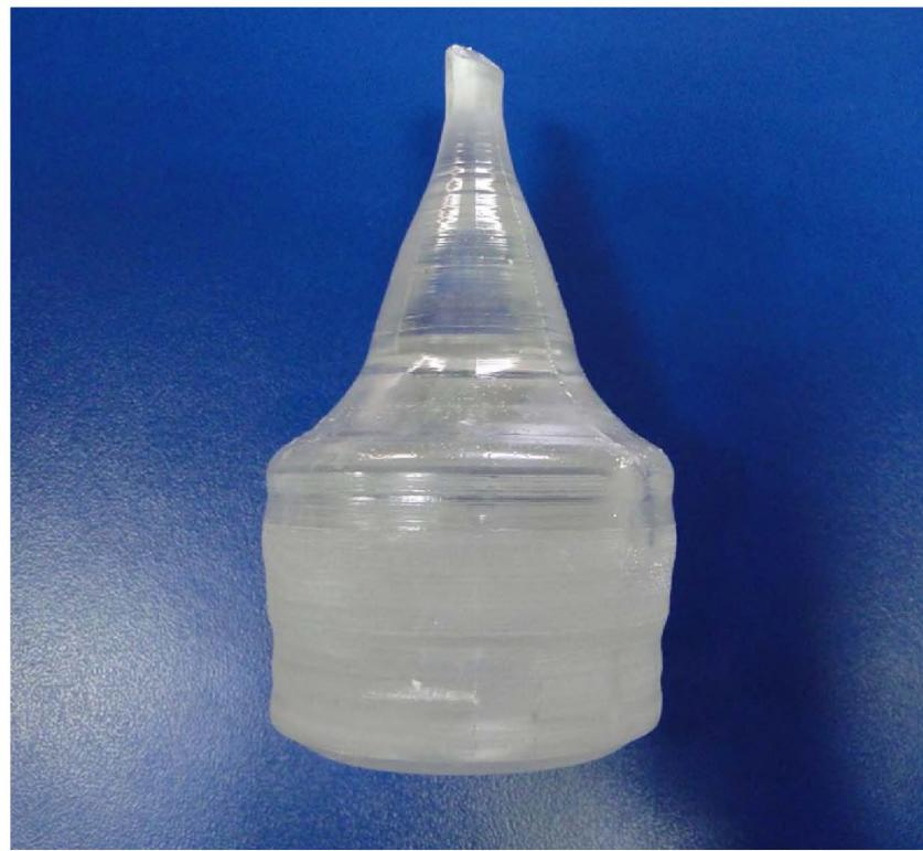
Рисунок 4.18 – Монокристалл парателлурита, выращенный с учетом понижения уровня расплава
