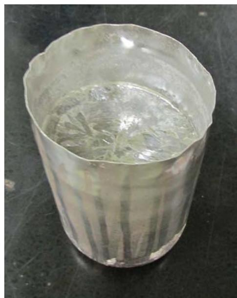
Рисунок 3.15 – Платиновый тигель диаметром 100 мм после вытягивания кристалла парателурита массой 880 г
