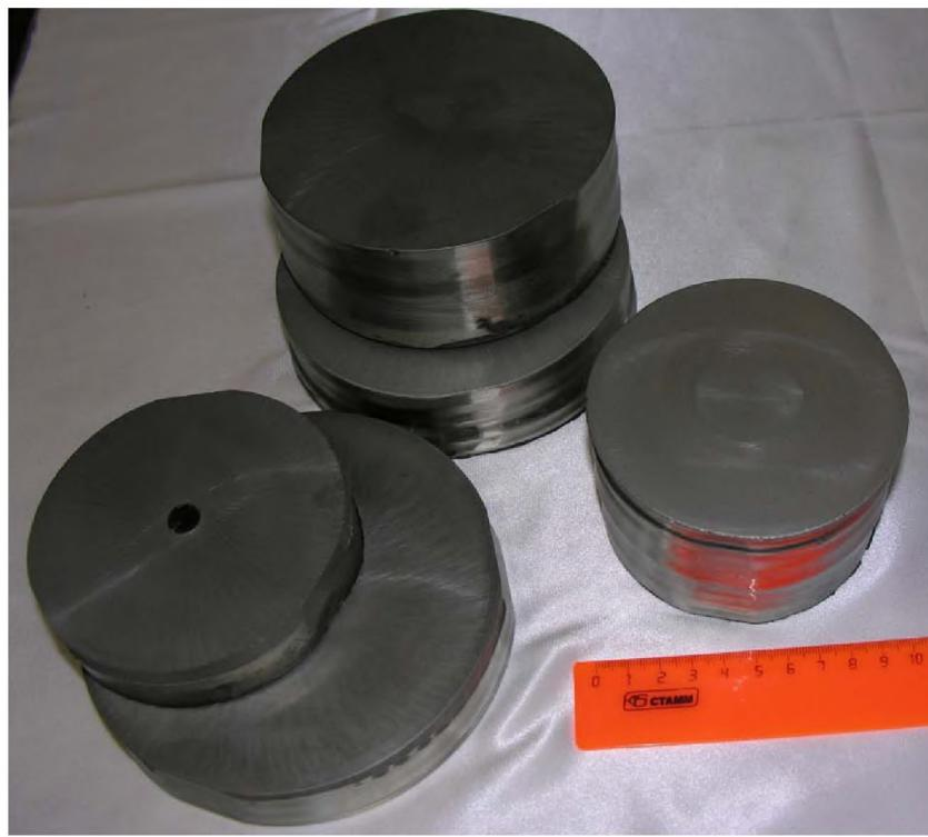
Рисунок 4.22 – Выращенные монокристаллы германия диаметром 100–150 мм
