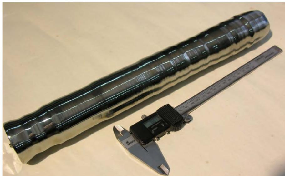
Рисунок 3.16 – Монокристалл германия со средним диаметром 60 мм ,
