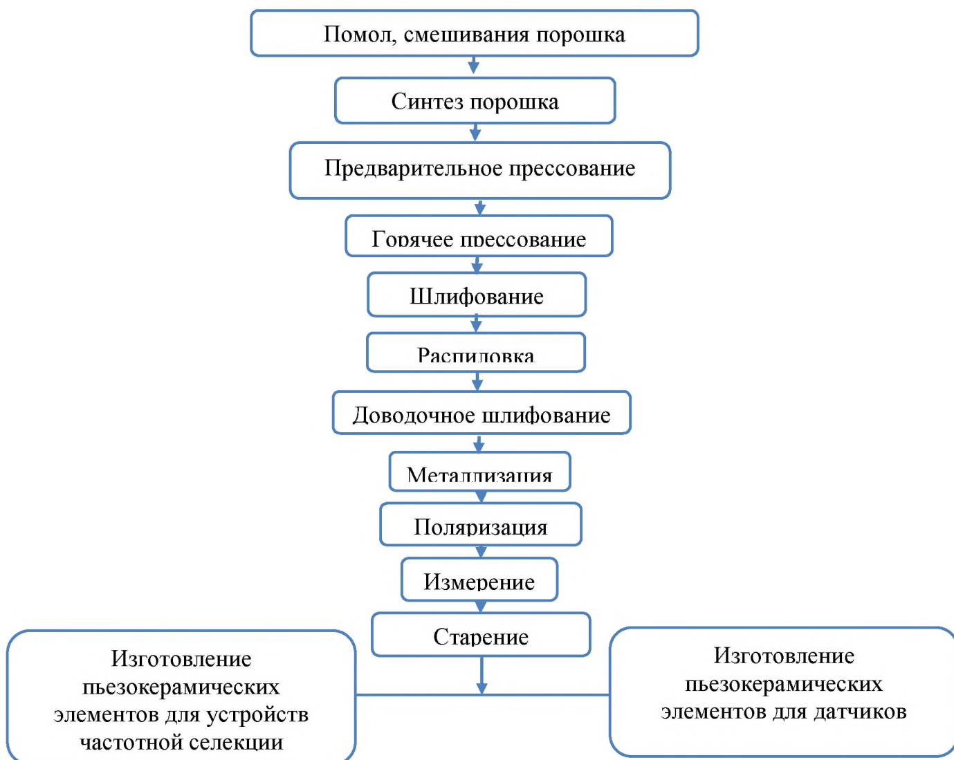
Рис.2.2. Маршрут изготовления пьезоматериала и устройств на его основе
