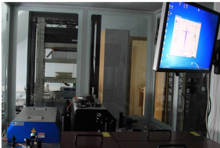
Рисунок 64. Фемтосекундный лазерный комплекс, использованный в исследованиях оптической однородности СЗП из парателлурита при включенной АОДЛ
