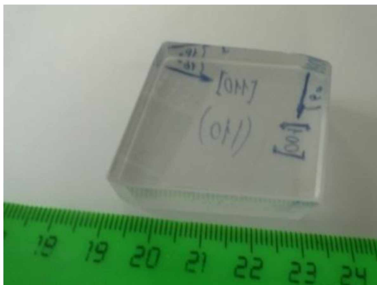
Рисунок 47. Экспериментальный образец одноосного монокристалла парателлурита с гранями, нормали к которым составляют с оптической осью углы \psi = 16^\circ и \psi = 84^\circ
