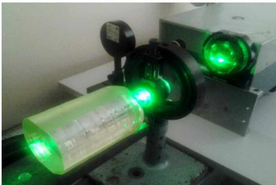
Рисунок 46. Крупногабаритная буля монокристалла LiNbO_3 на стенде для изучения коноскопических картин, получаемых с помощью лазера. Ось цилиндрической були совпадает с направлением оси конуса лазерных лучей
