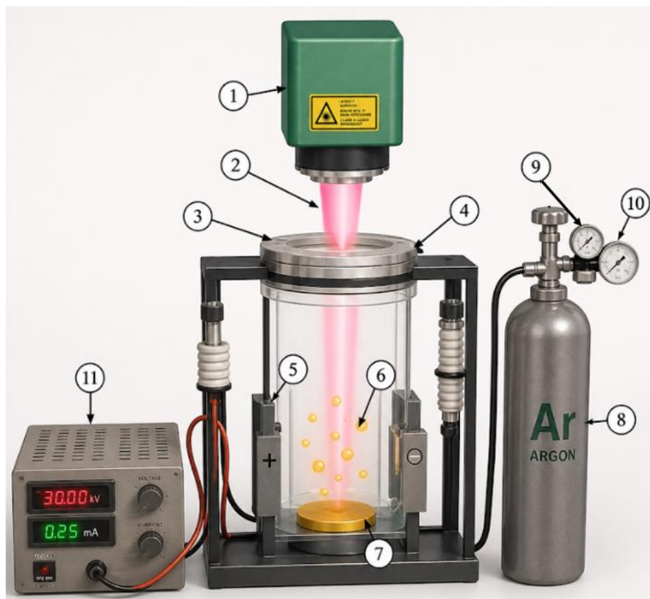
Рисунок 23 – Схема проведения эксперимента по синтезу наночастиц ZnS: 1 – гальваносканатор, 2 – лазерное излучение, 3 – реакционный сосуд, 4 – окно ввода излучения, 5 – кремниевые пластины для сбора материала, 6 – наночастица, 7 – образец ZnS, 8 – баллон с аргоном, 9 – расходомер газа, 10 – манометр, 11 – высоковольтный источник питания.
