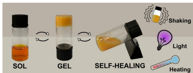
Рис.1.8. Самовосстанавливающиеся «золь-гель» и «гель-золь» переходы при воздействии внешних стимуляторов: температуры, света и механического встряхивания [100]
