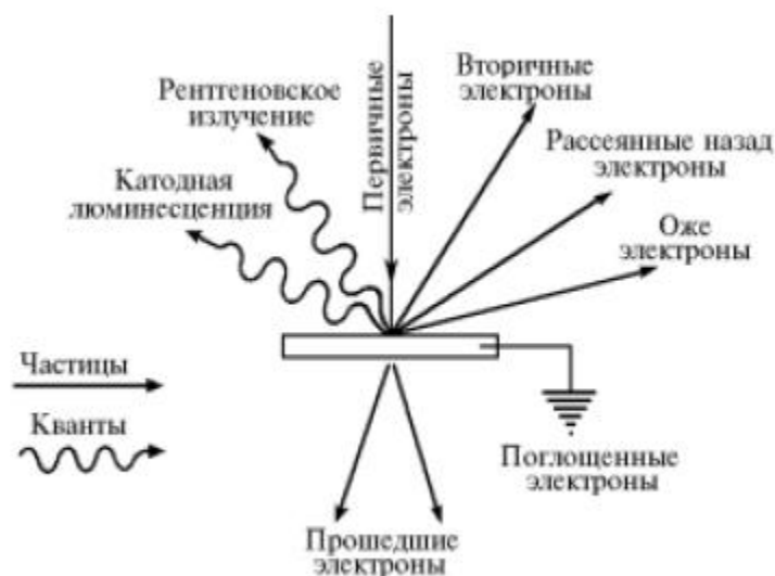
Рисунок. 14 Схема образования вторичных сигналов при взаимодействии электронного пучка с веществом.
