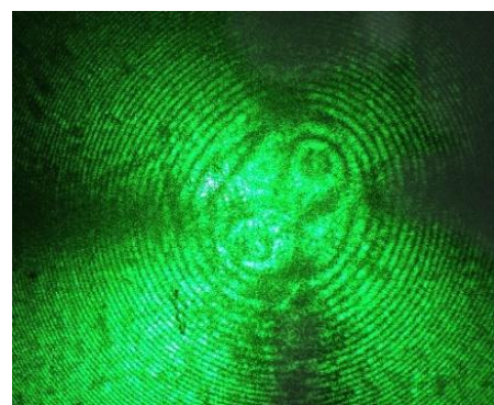
Рисунок 11 – Коноскопическая картина anomalously двуосного монокристалла ниобата лития, полученная с помощью лазерного излучения на полупрозрачном экране. Угол аномальной двуосности 2V = 50'
