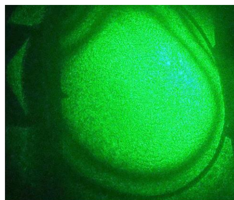
Рисунок 1 – Изохромы одноосного монокристалла парателлуриата в виде кривых выше второго порядка. Угол между нормалью к кристаллу и оптической осью составляет 17^\circ
