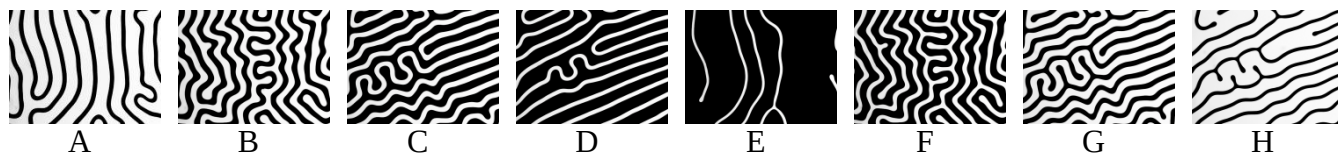
Рис. 4. Трансформация ДС бездефектного участка плёнки Bi: \Phi \Gamma в полях 0-0.04 Тл. Масштаб микрофотографии 415 \times 310 мкм.
