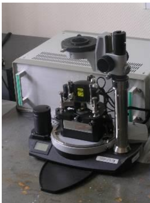
Рисунок 2.3.1. Внешний вид измерительной головки атомно-силового микроскопа SMENA-A.
