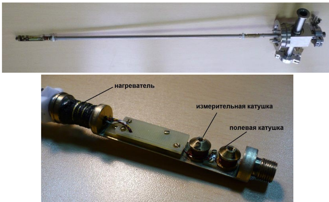
Рисунок 2.4.7. Измерительная вставка для измерения намагниченности (индукционный магнитометр) и держатель для установки образца.
