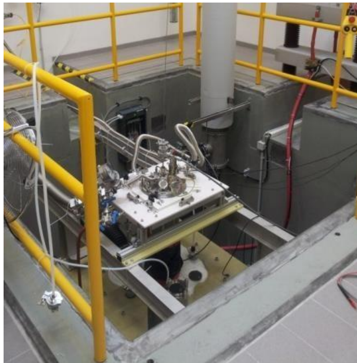
Рисунок 2.4.2. Магнетометр с образцом, помещенный в камеру с жидким гелием
