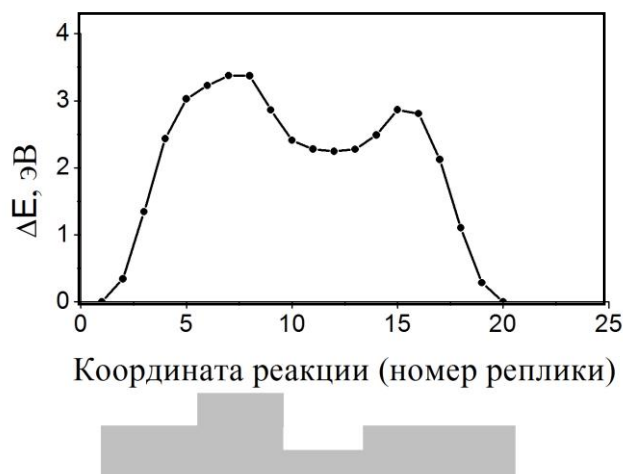
Рисунке 3.4.13. Профиль энергии для перемещения ДС в нанопроводе с комбинированным дефектом в виде расположенных рядом выступа и выреза прямоугольной формы на его длинной стороне. Ниже представлена упрощенное изображение нанопровода с таким дефектом
