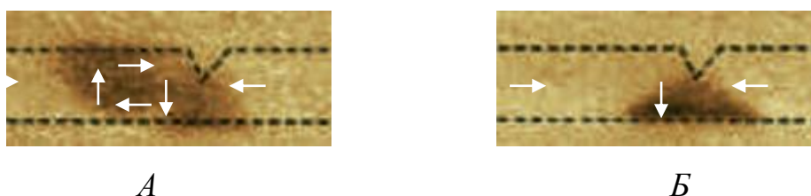
Рисунок 1.3.2. A – вихревая доменная стенка; B - поперечная доменная стенка [38]
