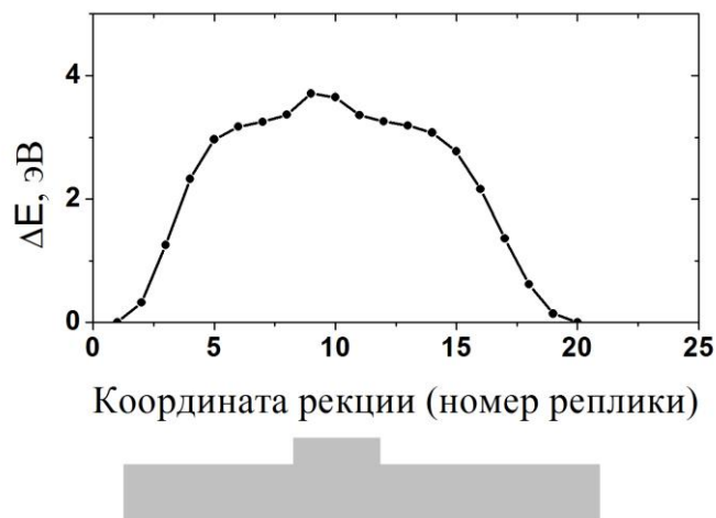
Рисунок 3.4.11. Профиль энергии для перемещения ДС в нанопроводе с выступом прямоугольной формы на его длинной стороне. Ниже представлена упрощенное изображение нанопровода с таким дефектом
