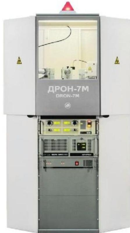
Рисунок 2.2. Рентгеновский дифрактометр ДРОН-7М
