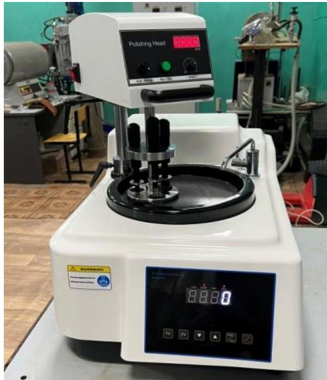
Рисунок 2.3. Шлифовально-полировальный станок Metapol 160E
