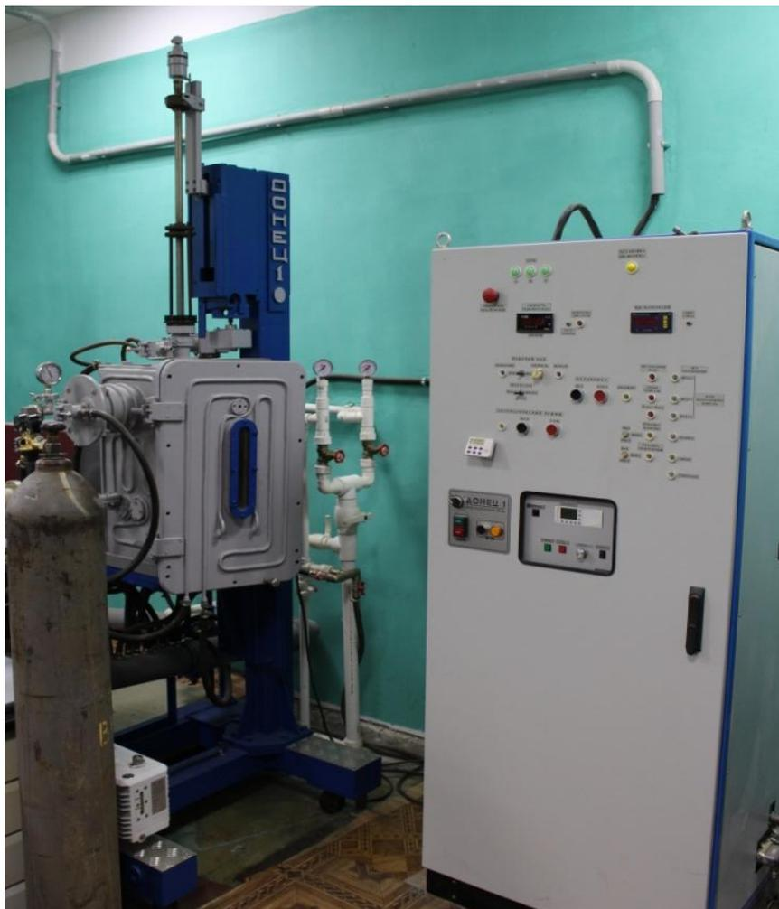
Рисунок 2.1. Установка для индукционной плавки
