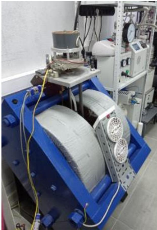
Рисунок 2.5. Вибрационный магнитометр
