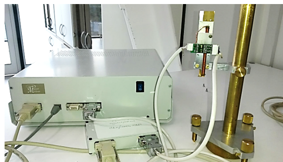
Рис. 2.4. б) Модифицированная установка для измерения петель гистерезиса индукционным методом.
