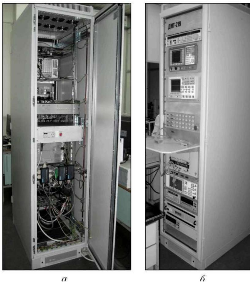
Рис. 3.12 Измерительный комплекс параметров ИМС «ДМТ-219»: а) вид сзади с открытой дверцей шкафа, б) вид спереди – лицевая часть шкафа с приборами
