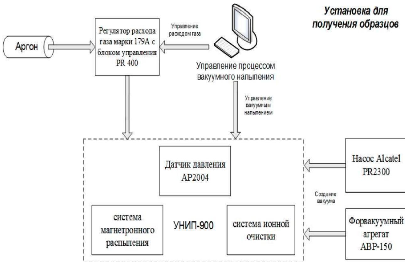
Рис. 4.1 Функциональная схема макета
