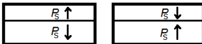
Рис. 2.23. Возможные направления поляризации в биморфе
