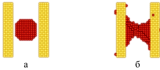
Рис. 10. Начальная (а) и конечная (б) конфигурация наносистемы Au_{2089} - Au_{429} - Au_{2089} , при температуре 293 К. Расстояние до дорожек наноразмерной шины 0,3 нм.
