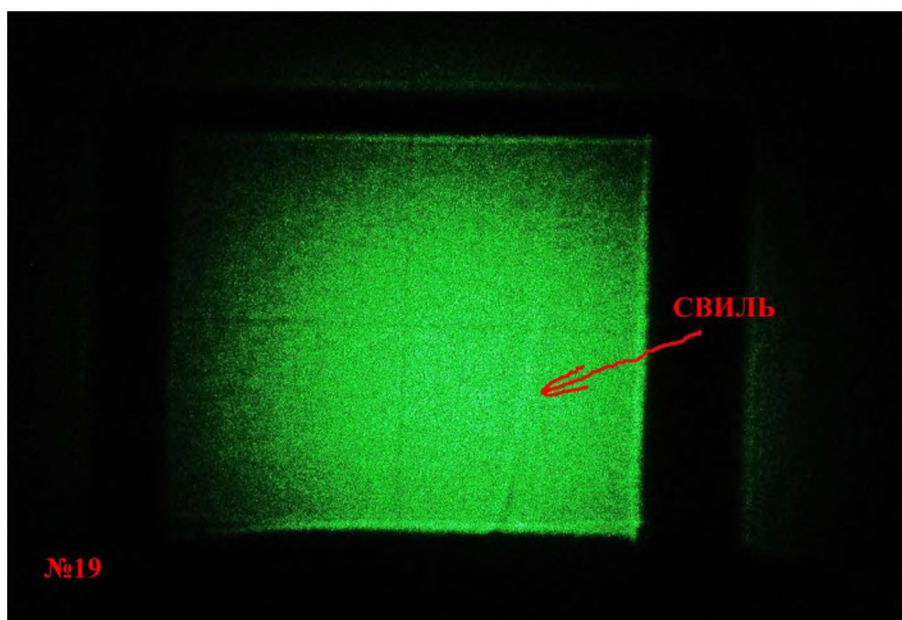
Рис.1.2. Свиль в крупногабаритном монокристалле парателлурита (отмечена стрелкой), наблюдаемая в пучке лазерного расходящегося света с длиной волны 533 нм на удалённом экране
