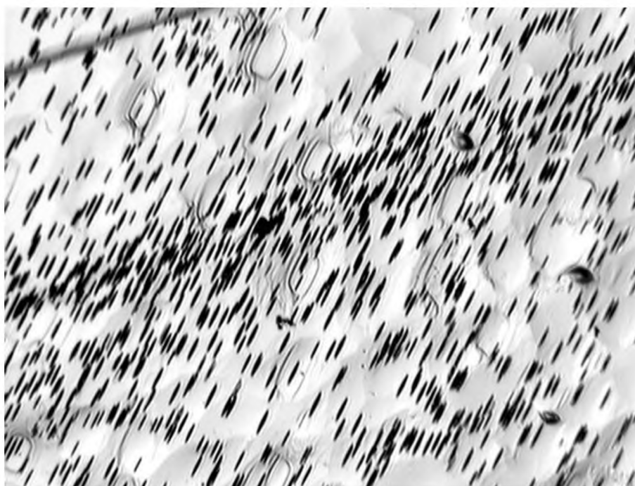
Рис.1.13. Дислокационные ямки травления участка поверхности кристалла парателлурифта (плоскость среза – (110) ) в области, содержащей свиль
