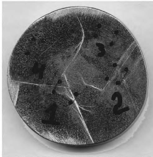
Рис.1.8. Монокристалл германия диаметром 52–55 мм с четырьмя выделенными областями, отличающимися плотностью дислокаций и наличием МУГ (малоугловых границ)
