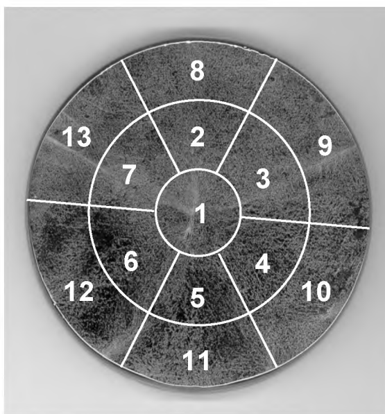
Рис.1.7. Поперечное сечение протравленного монокристалла германия, размеченное для локального анализа плотности дислокаций
