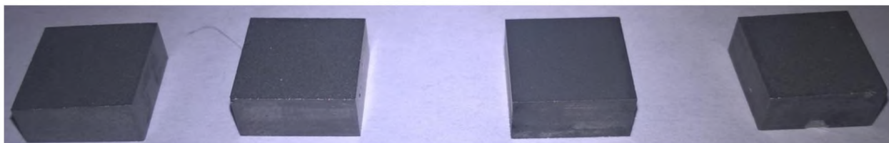
Рис.3.44. Образцы монокристаллов германия с различным удельным электросопротивлением
