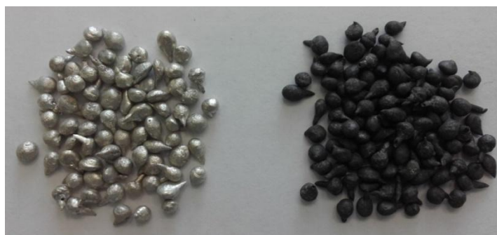
Рисунок 3.4 – Олово без (слева) и с поверхностными отложениями продуктов взаимодействия металла (справа)
