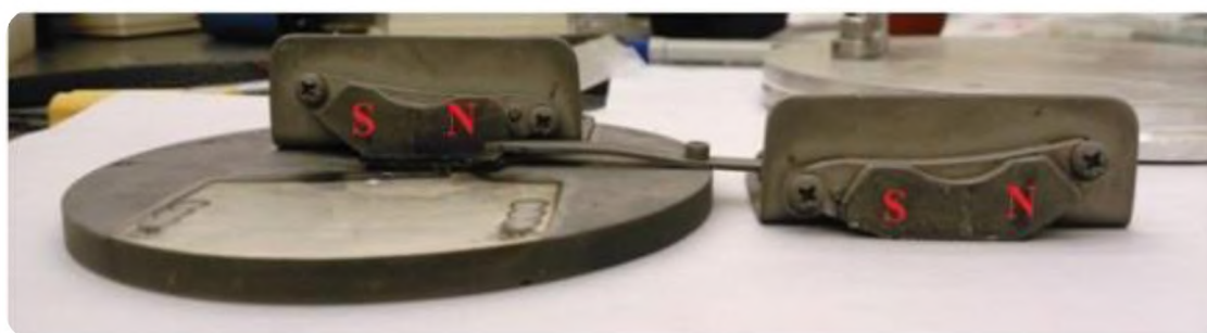
Рис. 2.1. Держатель подложки с закрепленными магнитами. Вид сверху. Магниты располагались друг напротив друга так, что северный полюс одного из магнитов находился напротив южного полюса другого магнита.
