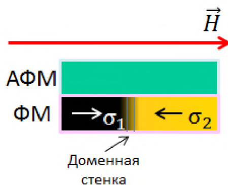
Рис. 1.4. Схематическое изображение двухслойной системы с интерфейсом ФМ/АФМ с доменной стенкой в ферромагнитном слое. \sigma_1 и \sigma_2 обозначают домены с противоположно направленными намагниченностями.
