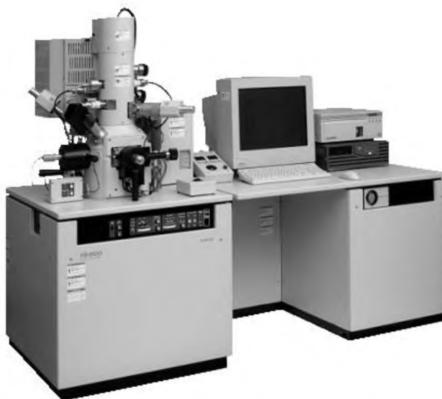
Рис. 2.7. Установка ФИП (справа) с управляющим компьютером (слева) [168].
