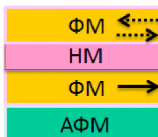
Рис. 1.7. Схематическое изображение структуры спинового вентиля. Сплошная стрелка обозначает условное направление намагниченности в закреплённом слое ферромагнетика. Штриховые стрелки обозначают альтернативные направления вектора намагниченности в свободном ферромагнитном слое.
