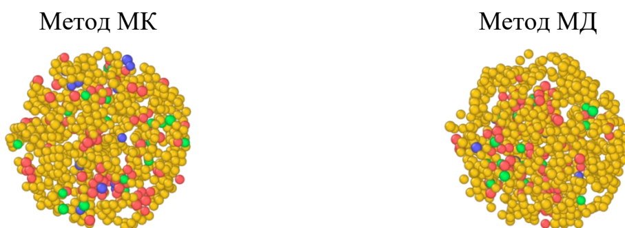
Рис 5.17. Внутренняя структура для биметаллических частиц Co-Au , полученные после охлаждения ( T = 300 К): зеленый цвет – атомы ГЦК структуры, красный цвет – ГПУ, синий цвет – ОЦК, желтый цвет – ИК ядра.
