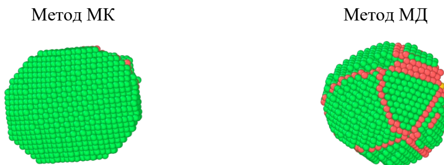
Рис. 5.15. Внутренняя структура для биметаллических частиц Ni-Cu , полученные после охлаждения ( T = 300 К): зеленый цвет – атомы ГЦК структуры, красный цвет – атомы ГПУ, желтый – ИК ядра.
