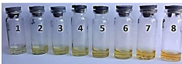
Рис. 3.1. Фотографии образцов ЦСР на основе L-цистеина и \text{AgNO}_2 сразу после смешивания исходных компонентов при концентрациях 0.01М и разных молярных соотношениях компонентов от 1.00/0.80 до 1.00/1.60.
