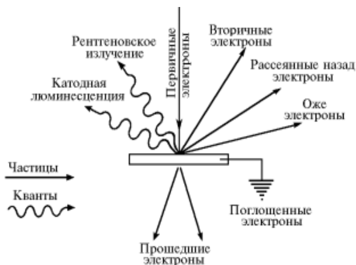
Рис. 2.7. Схема образования вторичных сигналов при взаимодействии электронов зонда с веществом мишени.
