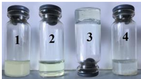
Рис.1. Фотографии свежеприготовленного ЦСР (1), «созревшего» ЦСР (2), геля с NaCl (3), осадка геля с NaCl через 30 дней стояния (4). C_{\text{Cys}}=3.0 мМ, C_{\text{Ag}^+}=3.75 мМ, C_{\text{NaCl}}=0.95 мМ.
