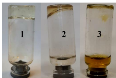
Рис. 13. Фотографии гидрогеля на основе ЦСР с ацетатом серебра в зависимости от времени УФ облучения: 1 – до облучения, 2 – 15 и 3 – 30 мин.
