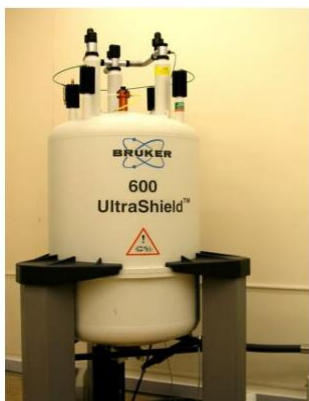
Рис. 2.7. Высокоэффективный сверхпроводящий ЯМР спектрометр Bruker AVANCE 600 (Германия).
