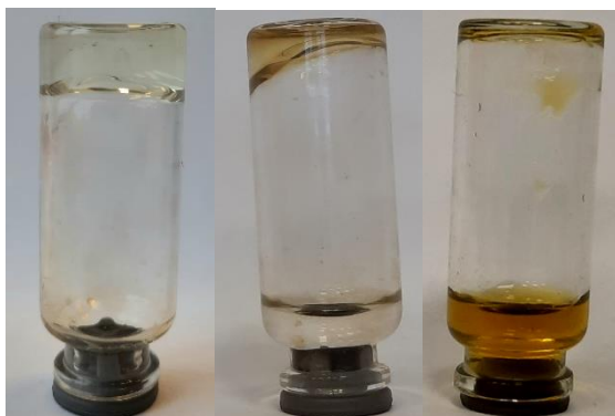
Рис. 4.6. Фотографии гидрогеля на основе ЦСР с ацетатом серебра в зависимости от времени УФ облучения: 1 – до облучения, 2 – 15 и 3 – 30 мин (3).
