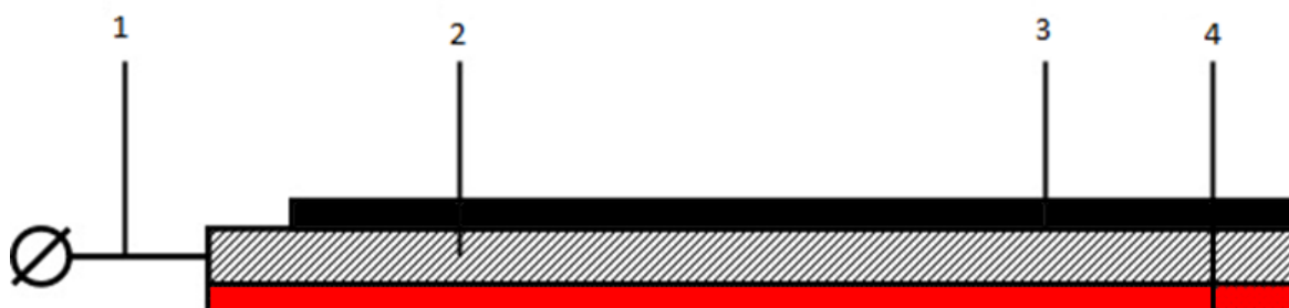
Рис. 2.1. Устройство актуатора: 1 – сигнальный кабель, 2 – платиновая подложка, 3 – слой полимера, 4 – изоляционный лак
