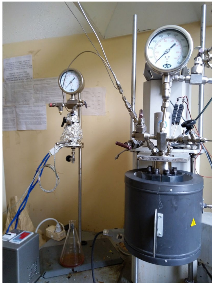
Рисунок 13 - Фото действующей экспериментальной установки для синтеза N-метил-D-глюкозими́на и N-метил-D-глюкозамина
