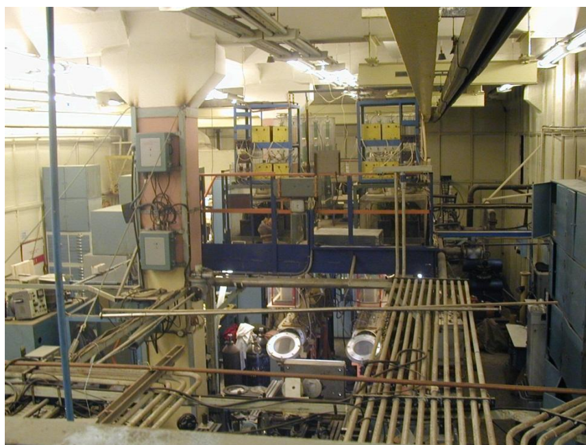
Рисунок 7 - Общий вид экспериментальной установки стенда для исследования характеристик импульсных электроразрядных лазеров. Лазерные кюветы с окнами Брюстера из монокристаллов NaCl диаметром 300 мм. Размеры рабочего объёма 1-й секции \sim 10 \times 10 \times 40 см
