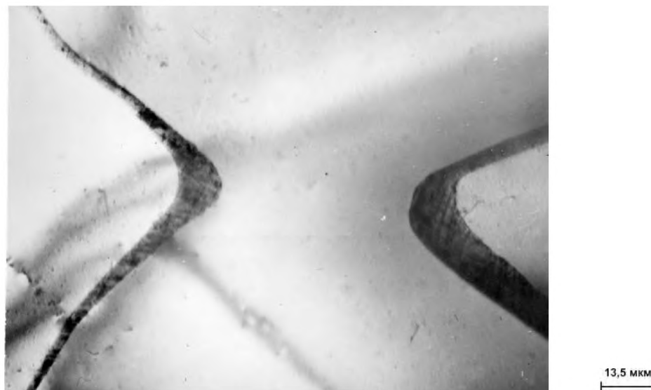
Рисунок 6.5 - Неравновесное положение границы зерна в закалённом сплаве БрХ после воздействия
