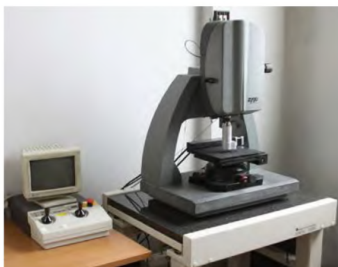
Рисунок 6.8 – Внешний вид и оптическая схема оптического профилометра Zygo New View 5000
