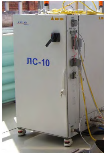
Рисунок 7.5 - Внешний вид 10 - киловаттного непрерывного волоконного иттербиевого лазера
