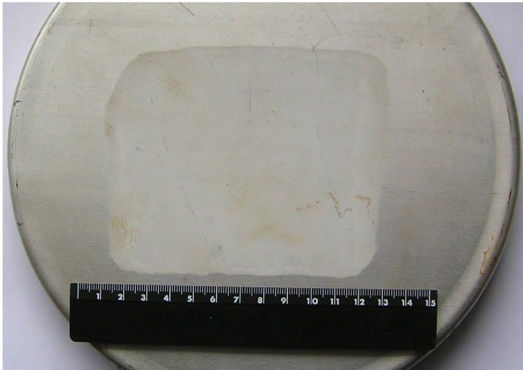
Рисунок 8.5 - След лазерного луча с энергией \sim 500 Дж на поверхности анодированного алюминия
