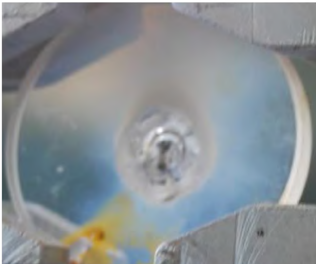
Рисунок 7.16 - Полированная пластина К-8, Ø30 мм после воздействия излучением 7 кВт, Ø пятна 0,33 мм, 1 сек
