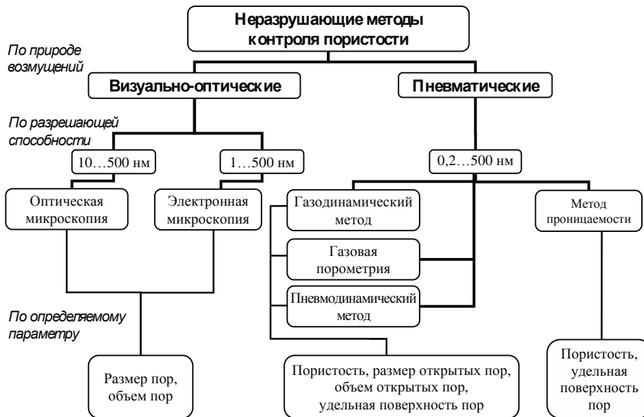
Рис.1.15. Классификация неразрушающих методов контроля пористости материалов [112]
