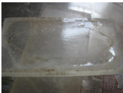
Рис. 2.2. Пленка термотропного полимера отлитая на окне из КВг
