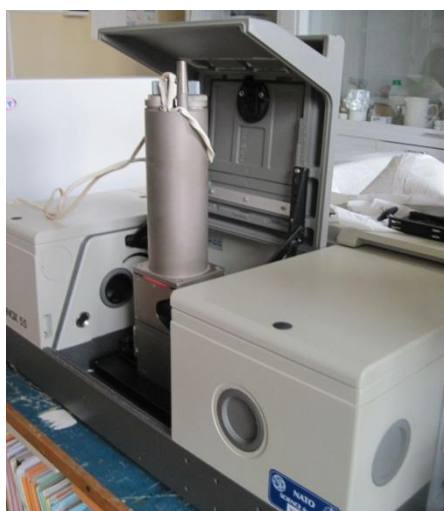
Рис. 2.5. ИК-Фурье спектрометр «Equinox 55» фирмы «Bruker» с термокуветой
