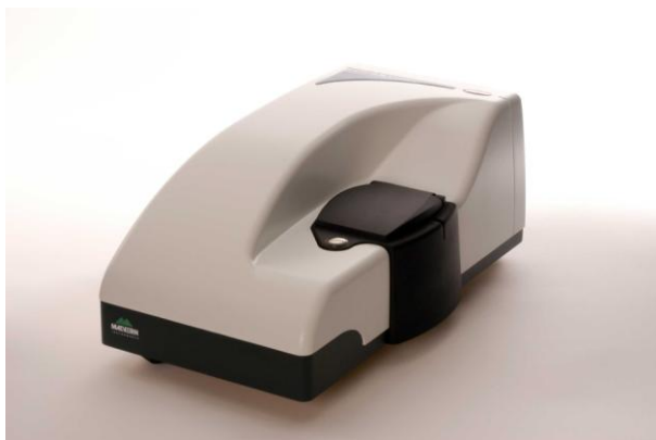
Рис. 2.3. Анализатор «Zetasizer ZS» («Malvern Instruments Ltd.», Великобритания) с He-Ne лазером ( \lambda=633 нм) мощностью 4 мВт
