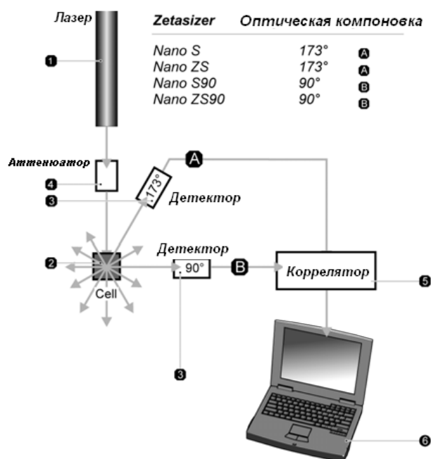
Рис. 2.4. Схема измерения размеров частиц на анализаторе «ZetasizerNano» [176]
