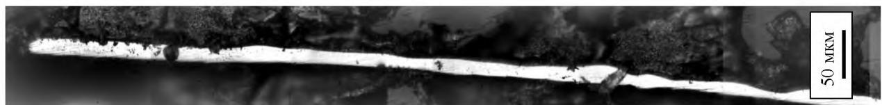
Рисунок 4.34 – Поперечное сечение быстрозакалённой ленты  $\text{Ni}_{52}\text{Mn}_{23.5}\text{Ga}_{23.5}$ .
