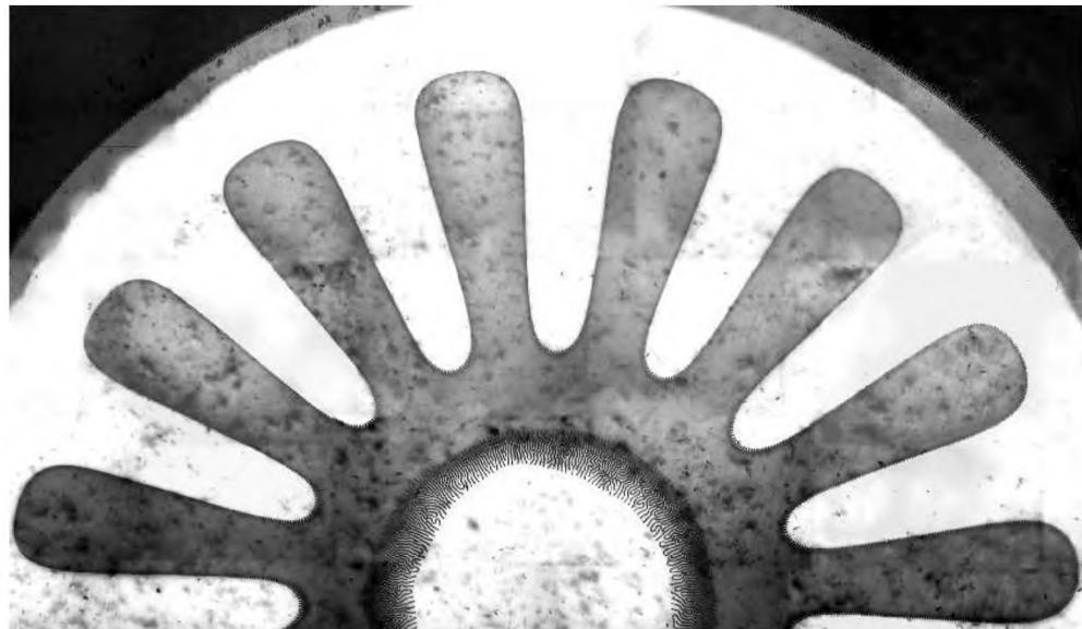
Рисунок 5.14 – Визуализация рабочего поля ротора (внешний диаметр 8 мм) с помощью одноосной индикаторной плёнки на расстоянии 50 мкм от поверхности
