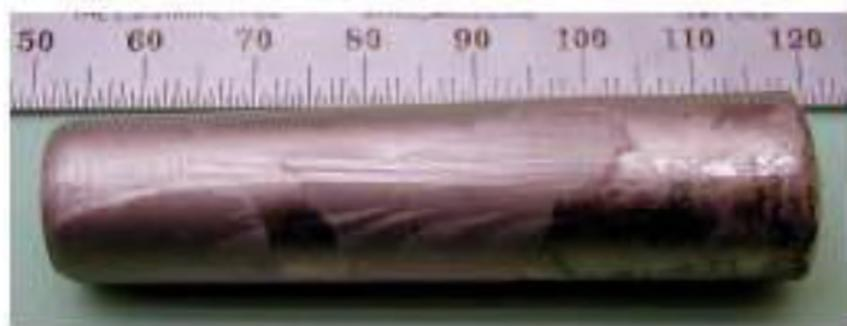
Рисунок 4.2 – Цилиндрический необработанный монокристалл  $\text{Co}_{48}\text{Ni}_{22}\text{Ga}_{28}$  диаметром 15 мм, выращенный при скорости вытягивания 20 мм/час.
