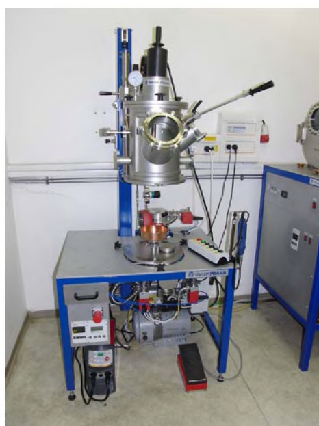
Рисунок 2.2.3. Система дуговой плавки в атмосфере аргона.
