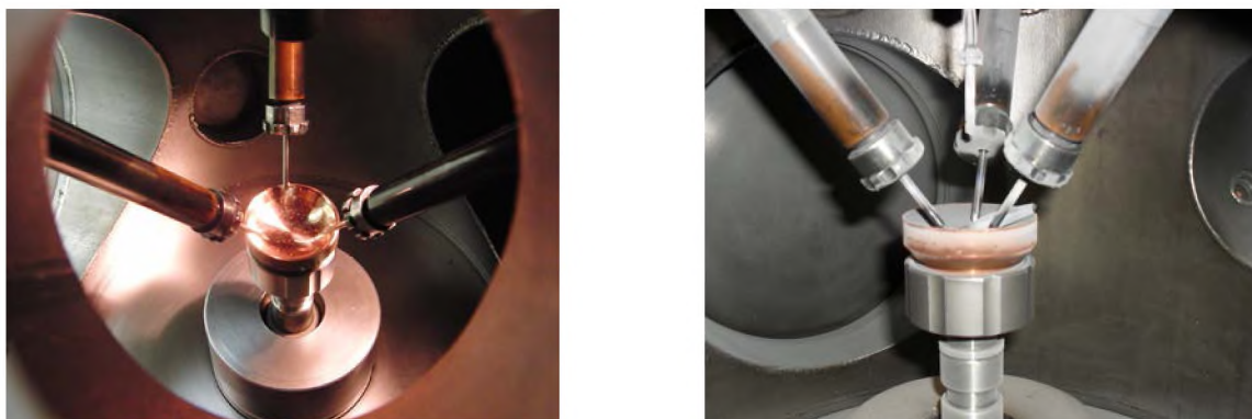
Рисунок 2.2.2. Установка для роста кристаллов модифицированным методом Чохральского, вид камеры изнутри. Водохлаждаемый под и три электрода.
