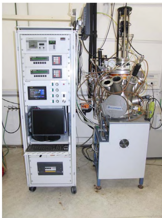
Рисунок 2.2.1. Внешний вид установки для выращивания кристаллов модифицированным методом Чохральского.
