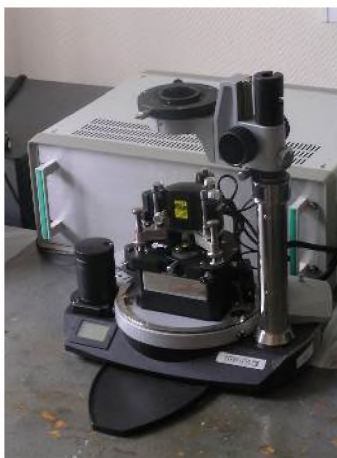
Рисунок 2.4.1. Внешний вид измерительной головки атомно-силового микроскопа.
